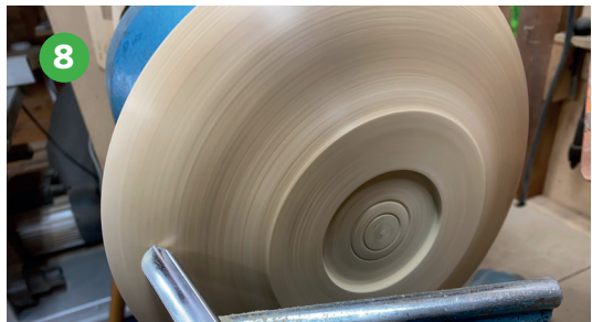
Foto 8 Opnieuw de buitenkant in vorm gedraaid.
