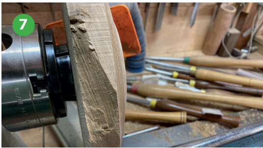
Foto 7 Onverwachts kwam er bij een scheurtje die ik niet had gezien een stuk eiken los en moest ik dus mijn vorm iets veranderen.
