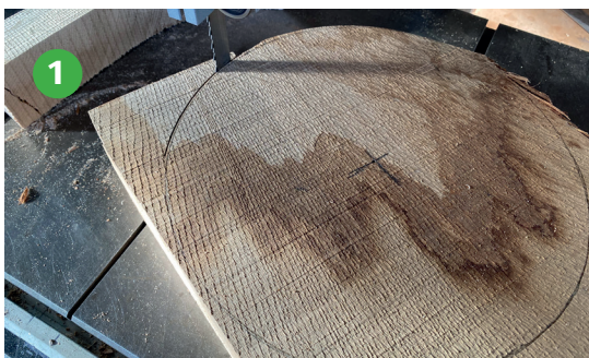
Foto 1 Uit een plaat eiken afkomstig uit de Keukenhof, "vals kwartier" gezaagd, dik 5,2cm, kan ik een schaal zagen van \varnothing 25\text{cm} .
