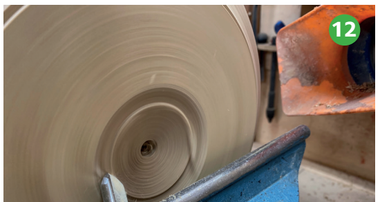
Foto 12 Ik start vanuit het midden met uithollen van de schaal.
