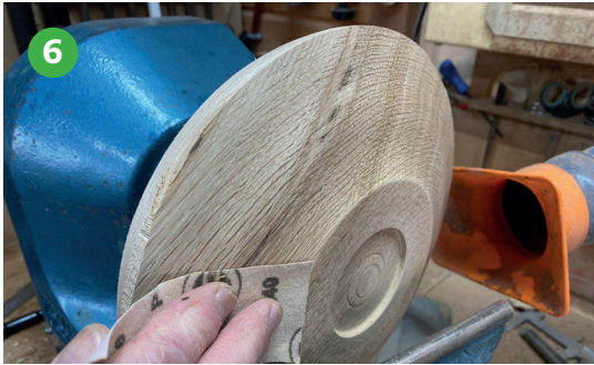
Foto 6 Met een scherpe guts draait het heerlijk glad en kan ik het schuren beginnen met korrel 240, 320 en 400.
