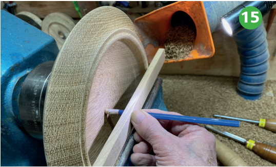
Foto 15 Ik mocht tot een diepte van 35mm gaan met uithollen zodat er 10mm boven het kamertje bleef staan.
