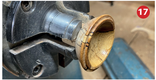
Foto 17 Het dekseltje wordt opgespannen in spigot bekken, uitgehold en afgewerkt.
