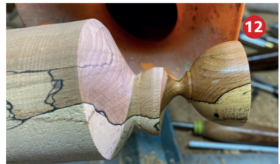
Foto 12 Het 2e vlak is gedraaid en de 1ste wobble (zo noem ik het maar) wordt in de juiste vorm gedraaid.
