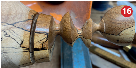
Foto 16 Vrij van de schroeven wordt het voetje afgestoken, nadat ook dit deel geschuurd en afgewerkt is met friction polish.
