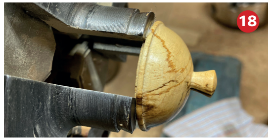
Foto 18 Het dekseltje wordt voorzichtig andersom opgespannen en er wordt een knopje aan gedraaid.
