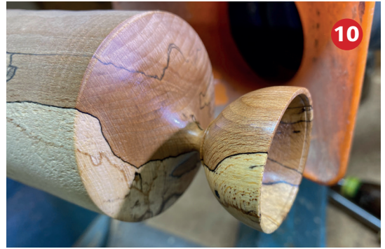
Foto 10 Het 1ste vlak is gedraaid, geschuurd en weer afgewerkt.
