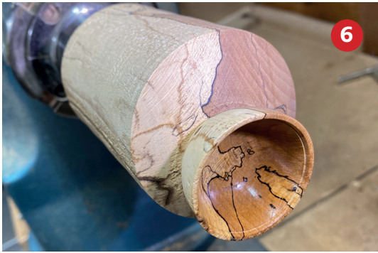
Foto 6 Het doosje is uitgehold met een gelijkmatige wanddikte. Omdat het later niet meer kan, wordt de binnenkant afgewerkt. Hier met friction Polish.
