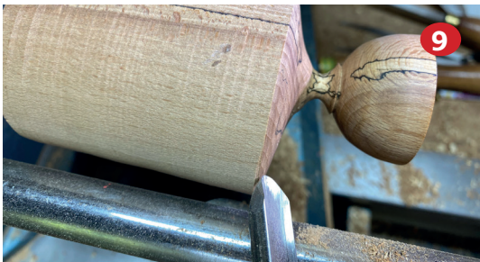
Foto 9 Voor het zwaarder werk gebruik ik een profiel guts met scherp geslepen hoek van 45°.
