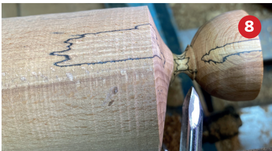
Foto 8 De profiel guts voor het fijne werk, met een scherp geslepen hoek van 30°.
