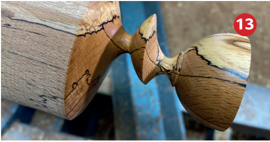
Foto 13 De 1ste wobble en het 2e vlak is af en wordt weer afgewerkt met friction polish.
