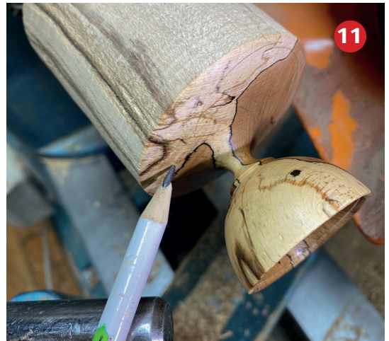
Foto 11 Nu wordt de wobble chuck weer gedraaid en teken ik ongeveer af tot hoever ik het af ga draaien. De verdraaiing van de chuck is een beetje op gevoel (hier 10mm) en met wat ervaring als je het meer gedaan hebt.
