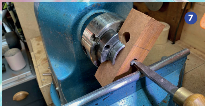
Foto 7 Nog een gat met draad gestreeld hier in het langshout.
