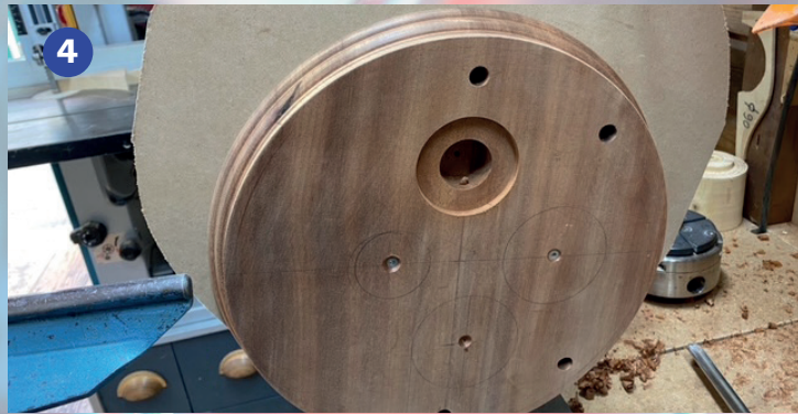
Foto 5 Voor de klem waar een hangend laboratorium glas in gaat maak ik verbindingen d.m.v draad strelen. Hier in kopshout mahonie.
