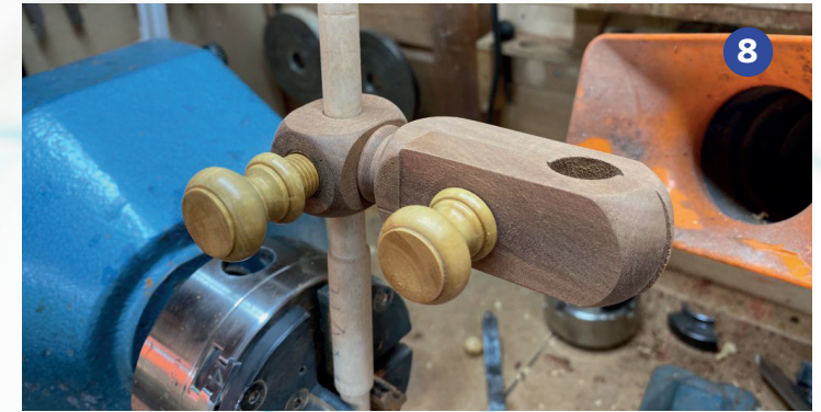
Foto 9 Alles in elkaar zetten. De ringen zijn gehalveerd.
