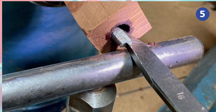
Foto 6 Het draadstrelen van de knop(pen) voor de klem uit buxus.
