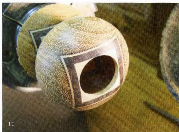
Foto 11 Na het schuren en afwerken wordt het gat voor het dekseltje op maat gedraaid. Zorg dat het palissander niet wordt geraakt.
