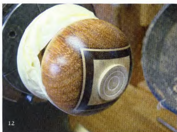
Foto 13 Het afgestoken stuk voor het dekseltje wordt in de klauwplaat opgespannen om de onderkant in vorm te draaien en het dekseltje passend te maken voor het doosje.
