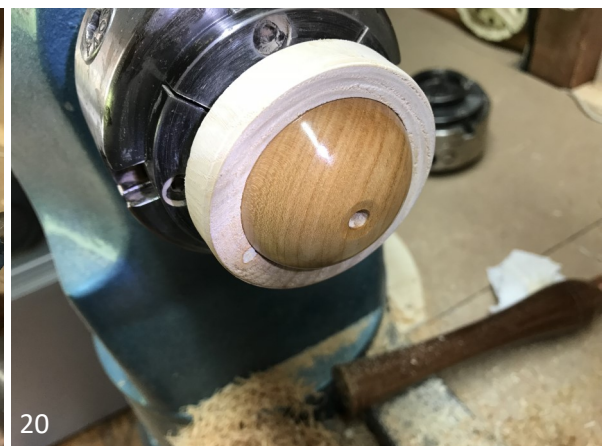
20. Bovenkant ook weer afgewerkt met friction polish.
