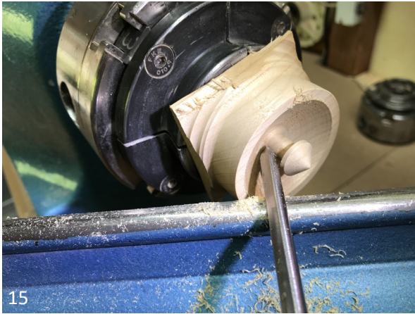
15. Met een 6mm guts hol ik het toletje uit.
