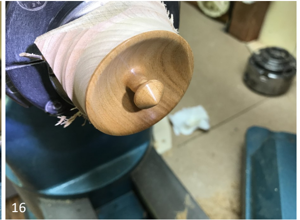
16. De afgewerkte binnen en onderkant van het toletje.
