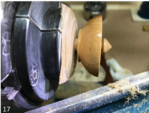
17. De bolle bovenkant van het toletje draaien, afwerken en afsteken.
