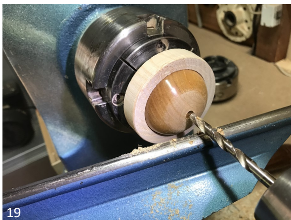
19. Het toletje is in het hulpstuk geklemd en ik boor een gaatje voor het steeltje op het toletje, \varnothing 6\text{mm} .
